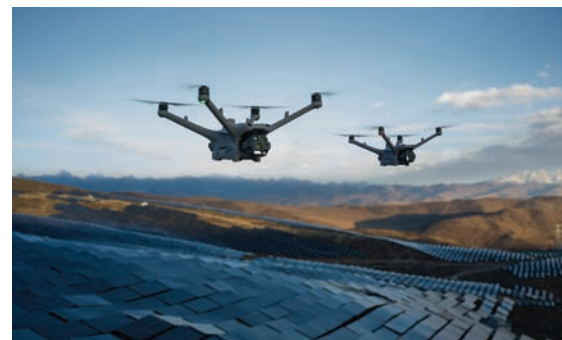
[사진4] Dock 3의 M4D-M4T(열화상 드론) 듀얼 드론을 활용한 태양광 발전소 무인 원격 관리
