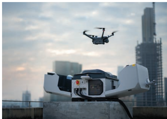
[사진2] Dock 3 station 도시 인프라 무인 원격 모니터링
