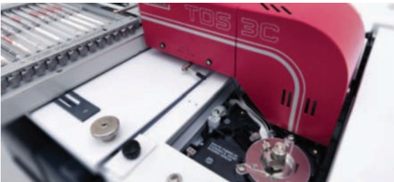
그림3. 7890GC와 5977A MSD에 장착된 Gerstel TDS system
