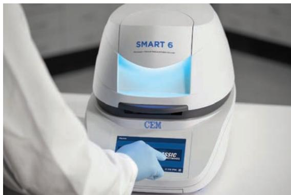
SMART 6는 마이크로웨이브를 가열원으로 사용하는, 세계 최고의 수분 및 고형분 함량 측정 시스템이다. 이 장비는 마이크로웨이브와 적외선, 두 가지 에너지원의 장점을 결합하여 거의 모든 시료의 수분과 고형분을 빠르고 정확하게 분석한다. 특허받은 이중 주파수 가열 기술은 다양한 시료와 응용 분야에 대해 탁월한 속도와 완성도 높은 건조 결과를 제공한다.
