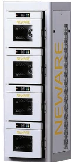
Neware사의 All-in-one battery cycler는 충방전 시험과 온도 제어 기능을 하나의 장비로 통합하여 다양한 배터리 테스트 요구를 충족시키는 고성능 배터리 충방전 시험기이다. 이 시스템은 소형 코인셀부터 대형 파워셀까지 다양한 배터리 유형 시험에 적합하며, 연구 개발(R&D), 품질 관리(QC), 배터리 대량 생산 등 다양한 환경에서 활용된다.
