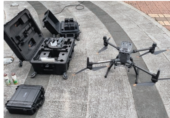
[그림 2] Zenmuse P1 카메라가 장착된 Matrice 350 RTK 드론
