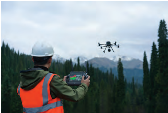
<그림1> Matrice 350 RTK와 Zenmuse L2를 활용하여 산림 점검을 수행 중인 모습
