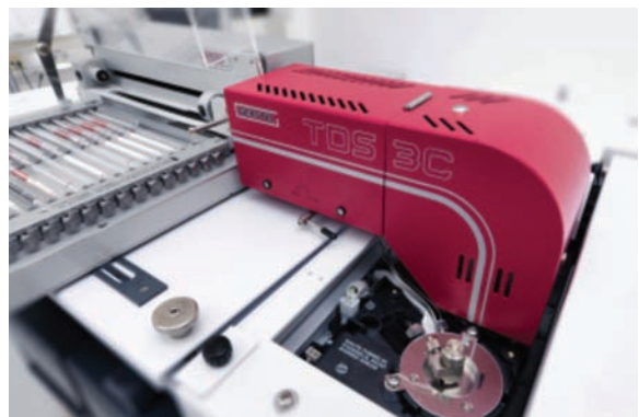
<그림3> 7890GC와 5977A MSD에 장착된 Gerstel TDS system
