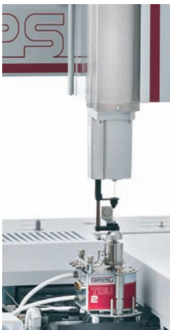
<그림 1> HIT-HS모드에서 TDU2로 스태틱 헤드스페이스 주입
