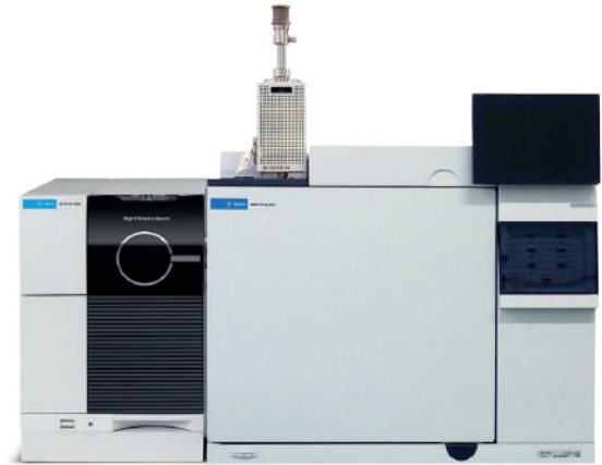
<그림 4> Py-GC/MS System (Frontier Lab사 Multi-Shot Pyrolyzer)
