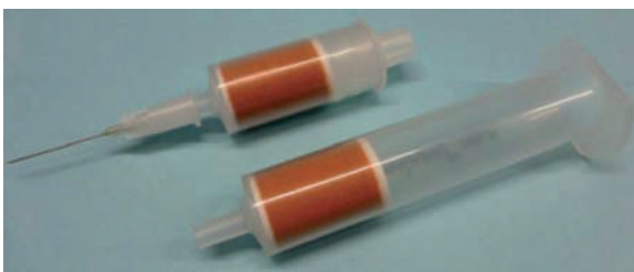
<그림 2> 위: GERSTEL MPS용 SPE카트리지, 아래: 일반적인 SPE카트리지
