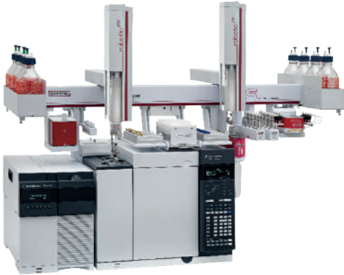
<그림 1> 타르 증류제품 내 benzo[a]pyrene과 benz[a]anthracene의 자동화 분석에 사용된 MPS Dual Head-GC/MSD 시스템
