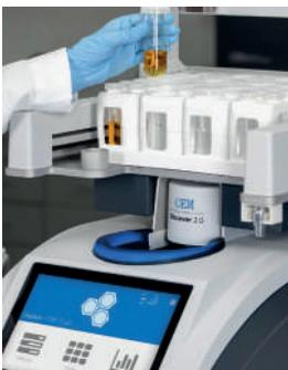
마이크로웨이브는 합성 화학에서 독보적인 가열 이점을 제공한다. 기존의 가열 방법은 가열원으로부터 열을 전달받아 가열되기 때문에 상대적으로 가열 시간이 느리고, 온도 제어가 어렵다. 반면에 마이크로웨이브를 이용한 가열은 분자와 이온의 마찰열을 이용한다. 이로 인해 물질의 직접
