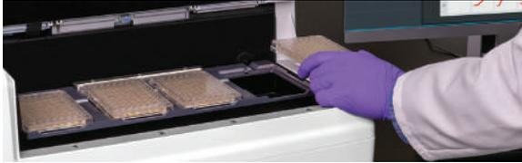
96-well plate 전용으로 설계되어 있으며, **최대 4장의 플레이트를 한 장비 안에서 사용할 수 있다.** 따라서 스크리닝과 같은 많은 시료를 측정해야 해야할 때, 여러 대의 장비를 사용할 필요없이 한 대로 실험이 가능하다.
