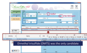
〈그림 5a〉 원소정보를 입력한 RI 교차 검색 결과(Sulfur는 포함, Nitrogen는 불포함하고 DB-Wax와 DB-5로 분석)
