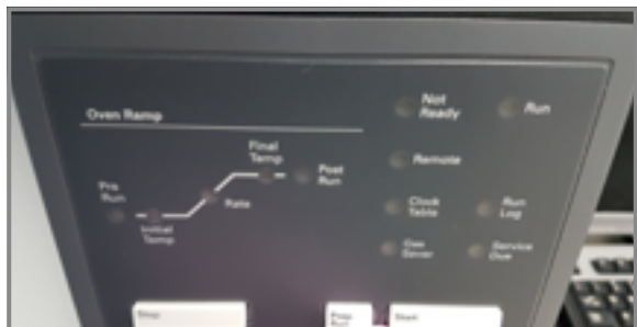
⑥ 50 °C에서부터 분당 1 °C 씩 올리면서 50 °C 씩 간격을 두고 120분 정도의 hold time을 주고, 최고온도에서 약 120분 정도 유지합니다(검출기, 메이크업 가스 오프 확인).
