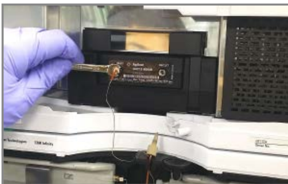
③ 스패너를 이용하여 inlet에 연결된 캐필러리 라인도 제거합니다.
