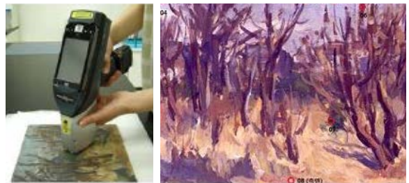
〈그림 1〉 휴대용 X선 형광분석기를 이용하는 모습 〈사진 출처: 국립현대 미술관 홈페이지〉
