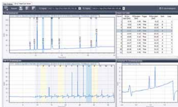
<그림 7> 2D-LC heart-cut viewer에서 나타내진 multiple heart-cutting 2D-LC 결과
