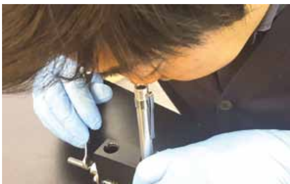
③ Nebulizer adjustment kit에 Nebulizer, LED 후레쉬, 40배 확대경을 장착합니다. 육안으로 확인합니다
