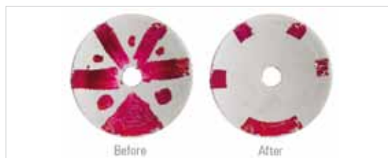
〈그림 2〉 JetClean Self-Cleaning ion source 모듈에서 빨간색 잉크로 낙서한 이온화원 렌즈의 자동 세척 전후
