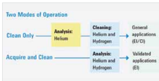
〈그림 1〉 Agilent JetClean Self-Cleaning ion source 모듈의 두 가지 사용 모드
