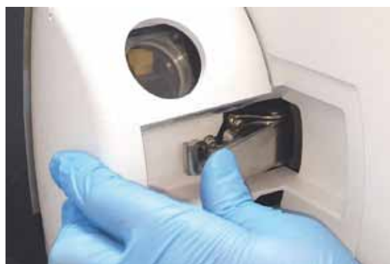
⑦ Nebulizer에 Nebulizer gas tubing 등을 연결해 줍니다.
