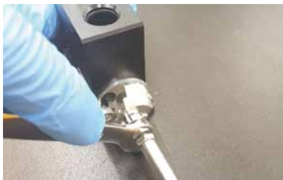
④ 1/4인치 스패너를 이용하여 길이를 조절합니다.
