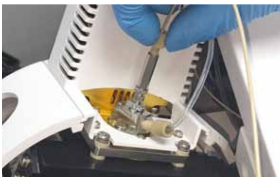
② Nebulizer에 연결된 Nebulizer gas tubing 등을 풀고, Nebulizer를 꺼냅니다.
