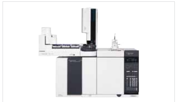
〈그림 2〉 Agilent 7890B GC와 8355 SCD
