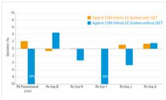
〈그림 6〉 Agilent 1290 Infinity 시스템을 이용하여 얻은 성분별 resolution 차이 비교 (ISET 활용 전/후)
