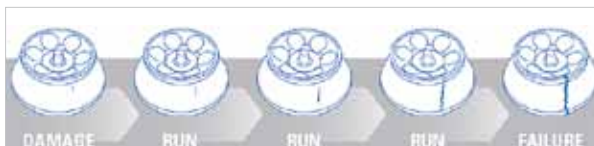
〈그림 2〉 수명이 다한 로터 원심분리 시, 로터의 균열발생 과정
