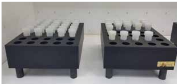
<그림 11> Heating block에서의 암석광물 시료분해 시스템
