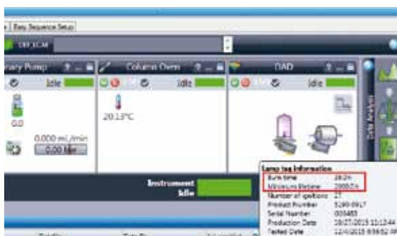
⑤ 버닝타임(램프 사용시간)과 미니멈 라이프타임(램프의 수명시간)을 확인합니다. 버닝타임이 미니멈 라이프타임을 초과하는 경우 새 램프로 교체합니다.
