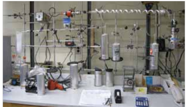
〈그림 5〉 물의 DIC(Dissolved Inorganic Carbon) 중 CO 2 추출장치 및 C-14 CO 2 분리 진공라인
