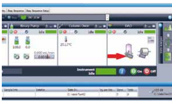
④ 램프 TAG로 마우스 커서를 이동합니다.(OpenLAB CDS ChemStation 버전에 따라 상이할 수 있습니다.)
