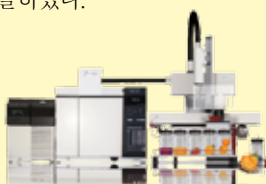
헤드스페이스-GC/MS 주입 시스템
