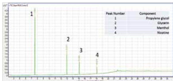
〈그림 1〉 민트향 전자담배 액상 1% 디클로로메탄 용액을 50:1 분할 모드로 주입하여 분석한 Scan TIC 그림
