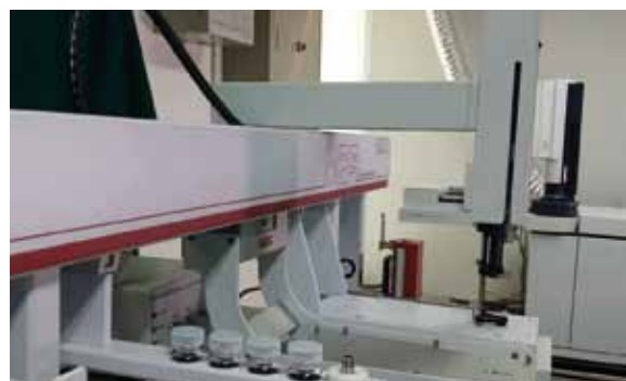
⑥ Lower Needle Guide의 홈이 Holder Hole 중앙에 위치하도록 X, Y, Z를 조정합니다.
