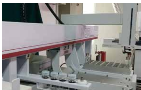
⑫ Check Position을 선택하여 Vial이 1, 8, 32에 위치하는지 확인합니다. 포지션을 확인하고, Home키를 눌러 완료합니다.
