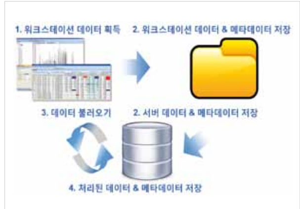
〈그림 3〉 Agilent 다중사용자시스템의 구성과 기록관리방법
