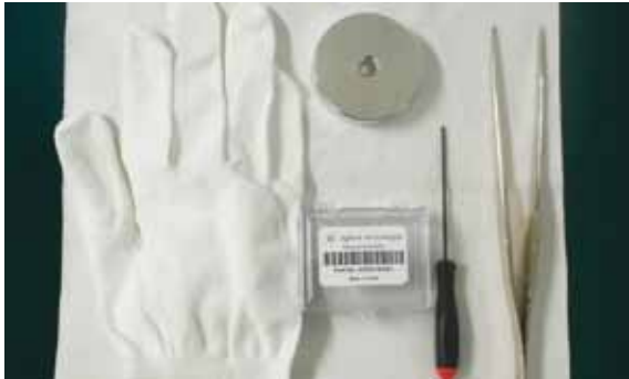
① GC/MSD Filament 교체 시 필요한 소모품 및 도구입니다. 교체할 Filament(PN: G7005-60061)와 1.5 mm 육각 드라이버, 소스 받침대, 핀셋 등이 필요합니다.
