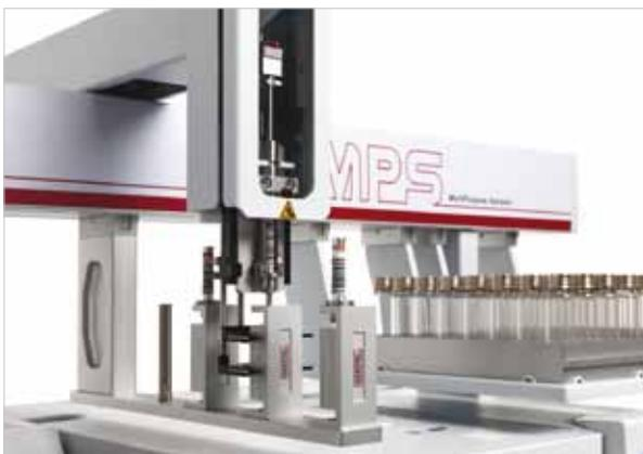
〈그림 8〉 SPME fiber를 자동으로 교체하여 분석법 개발 시간을 단축시켜 주는 GERSTEL사 MFX(Multi Fiber Exchange) 시스템
