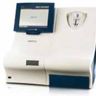
특히, AQT90 FLEX는 기존의 D-dimer 측정 장비와 달리 혈액을 채혈한 튜브를 회석하지 않고 바로 장비에 장착, 검사를 실시하므로 검사자도 빠르고 안전하게 검사할 수 있다.
