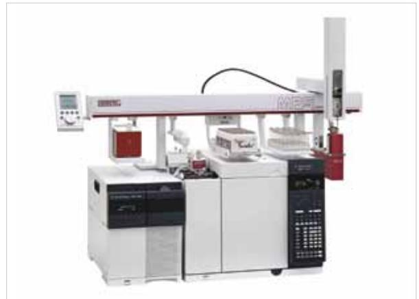
〈그림 16〉 GERSTEL사 MPS-TDU-CIS 시스템
