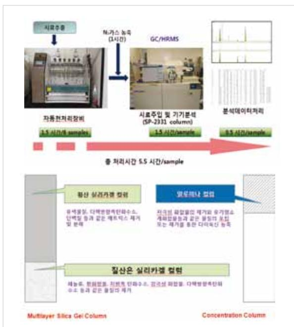
(그림 2) 다이옥신 시료전처리 시간 및 컬럼 구성
