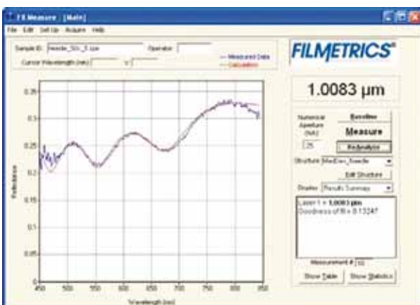
(그림 4) F40을 이용한 Polymer-Coated Needle의 측정 결과
