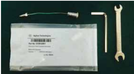
① Needle Seat을 교체하기 위해서는 Needle Seat, 렌치, 1/4 inch 스패너가 필요합니다.
