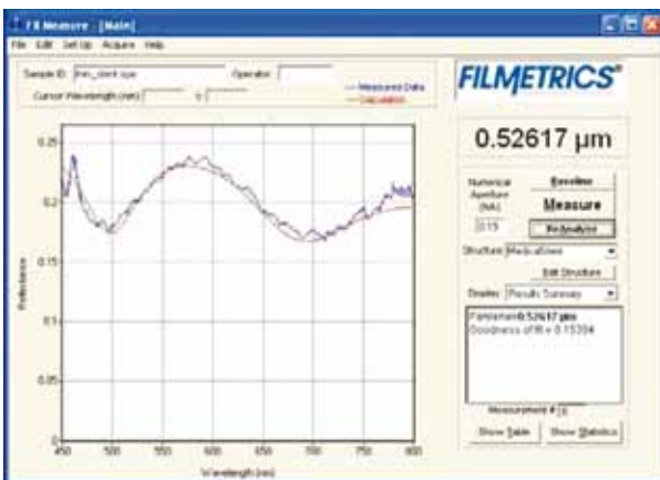
(그림 3) F40을 이용한 Drug-Coated Stent 측정 결과
