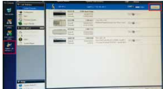
② 장비 전원을 켜 후 Lab Advisor SW를 실행한 후, 우측상단의 Connect 버튼을 클릭합니다. Service & Diagnostics 메뉴를 클릭하여, ALS → Maintenance positions → 하단에 있는 Run을 클릭합니다. Change Needle에서 Start를 클릭합니다. OK를 눌러 진행시킵니다.
