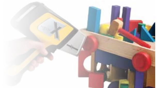
휴대용 성분 분석기, 휴대용 XRF, XRF 장비, PMI 장비, 포터블 XRF, 중금속간이측정기 등 불리는 이름은 다양하지만, 이것은 하나의 장비를 말하는 것이다. 휴대용 성분 분석기는 주로 건 타입의 형태를 지니며 리튬 이온 배터리를 사용해 X선을 만들어 낸다. 이렇게 생성된 X선을 시료에 조사하면 형광분석원리에 의해 성분을 분석할 수 있다.
