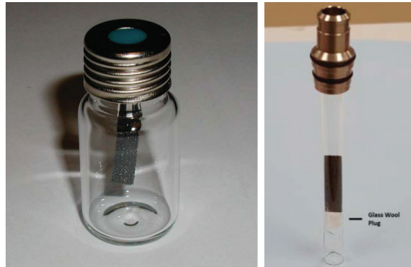
<그림 1> 10 mL vial 내 TF-SPME <그림 2> TDU tube 내 TF-SPME
