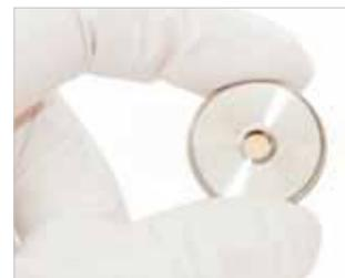
(그림 3) Chip-based FAIMS 장치의 예
