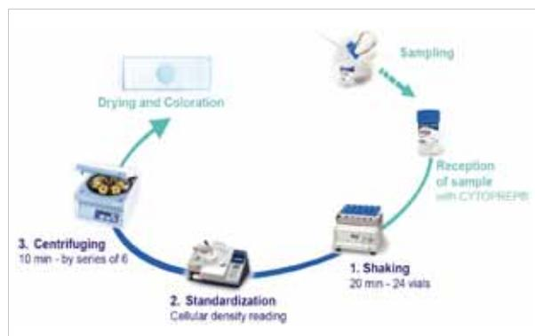
(그림 3) Direct Centrifugation 방식
