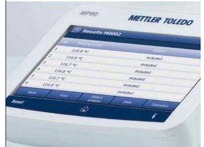
최대 60개의 분석법으로 작업하여 신속하고 효율적으로 다양한 측정을 수행하십시오. 결과는 실험 후 즉시 표시되며, 최대 100개의 결과가 자동으로 저장되고, 언제든지 기기에서 직접 액세스할 수 있습니다.
