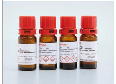
간단한 내장형 교정(Calibration) 루틴을 통해 기기를 빠르게 조정할 수 있습니다. 최대 세 개의 물질로 교정(Calibration)을 수행하십시오. 기기가 기울기 및 오프셋 수치를 자동으로 계산해 줍니다.
